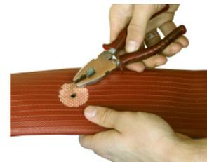
2a) Le diamètre de la Rustine doit être plus petit que la surface récurée afin de permettre une meilleure vulcanisation.
